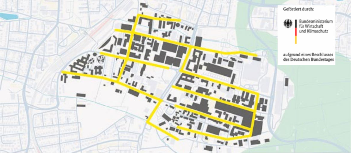
Übersicht Trassenführung Wärmenetz
