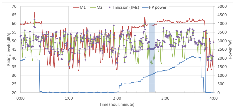
Abbildung 134: Beurteilungspegel nahe der Wärmepumpe (M1), der Umgebung (M2) und am Bewertungspunkt (IMs) sowie elektrische Leistungsaufnahme des Verdichters über einen Beispielzeitraum von 4 Stunden
